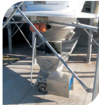
Particolare del motovibratore collegato al fungo interno del cono vibrante, che assicura una perfetta discesa del latte in polvere contenuto nel silo
