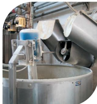
Coclie di estrazione del latte dal silo e scarico nel bollitore, senza testata per evitare intasamenti causati dal vapore
